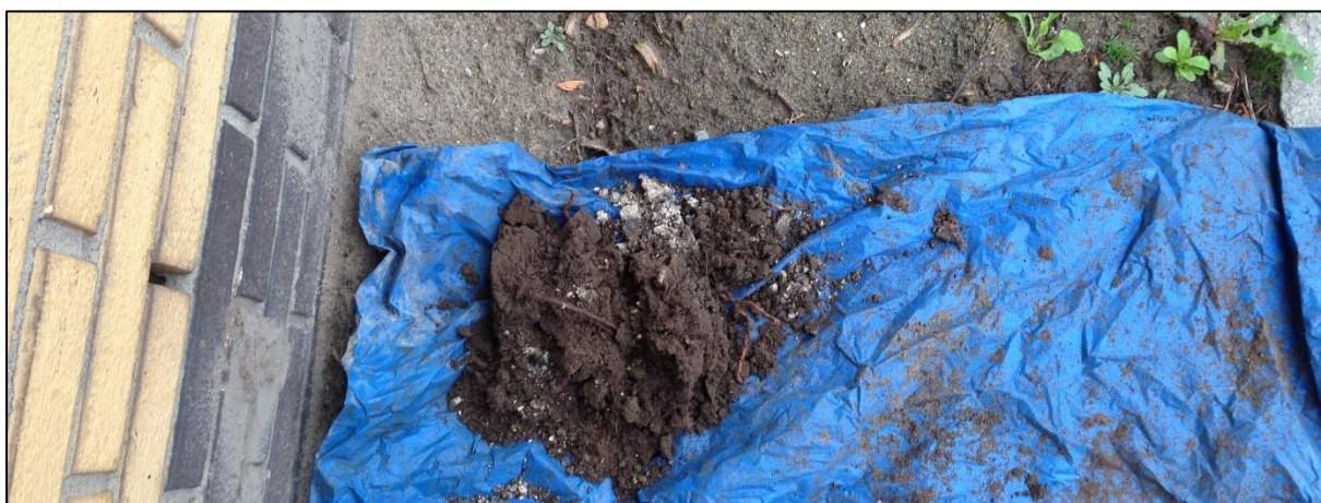
Boring 6: 0-35 cm -Mv, meermaals gestaakt in een puinpakket. Deze boring is indicatief voor boringen 2 tot en met 5.
