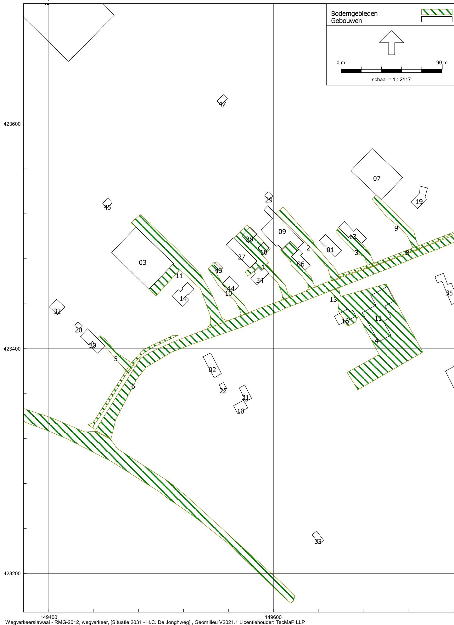
figuur 4: Overzicht rekenmodel met posities objecten en bodemvlakken
