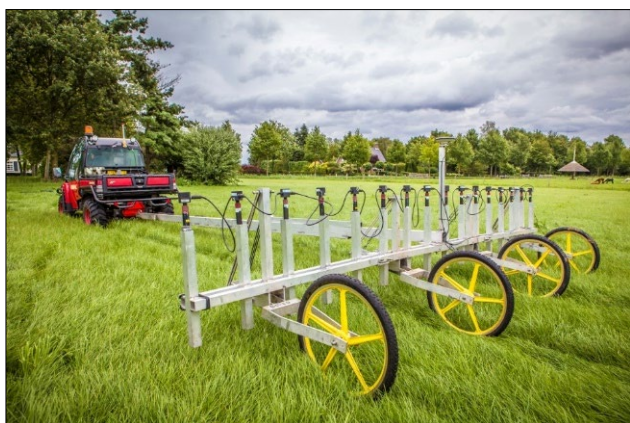
Figuur 14. Passieve non realtime oppervlakedetectie met het Vallon Multisondesysteem VXV16 en een staafdiagram waarop het maximale detectiebereik ( m^2 - maaiveld) per kaliber is weergegeven.
