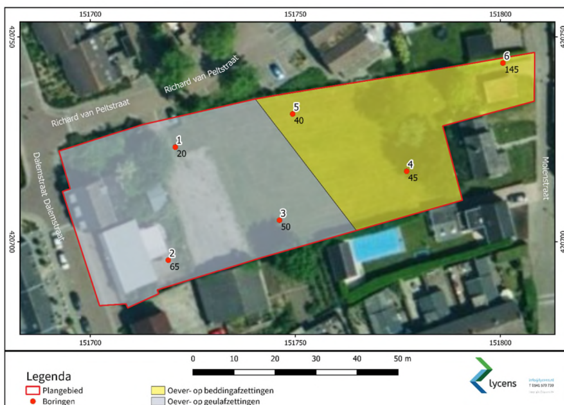
Afb. 17. Resultaten van het booronderzoek. Diepte geroerde grond in cm – mv aangegeven.
