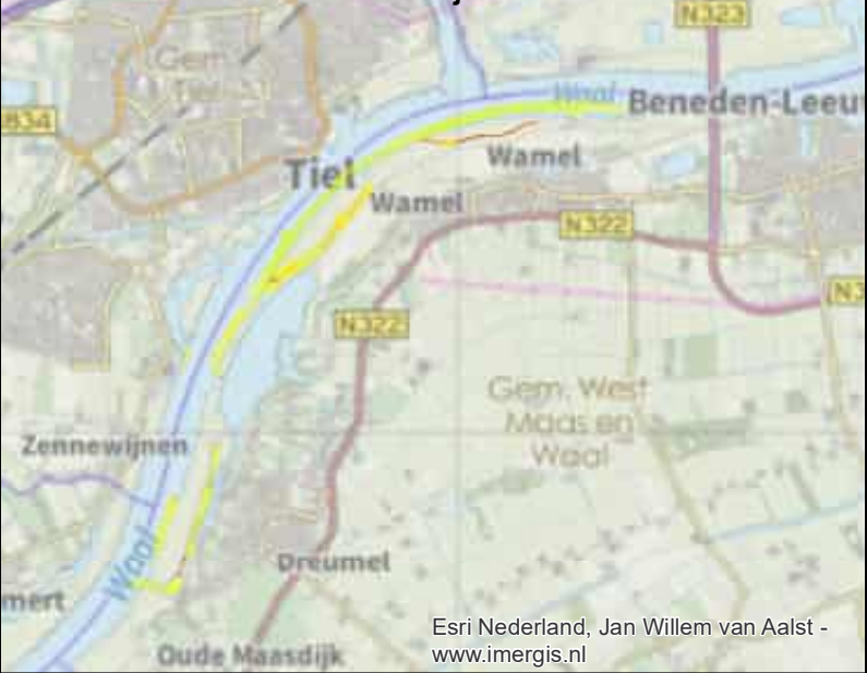
2. Stroomsnelheidsverschillen bij 2.000 m3/s
