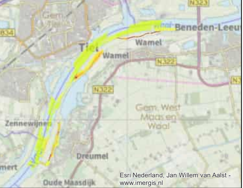
3. Stroomsnelheidsverschillen bij 3.000 m3/s
