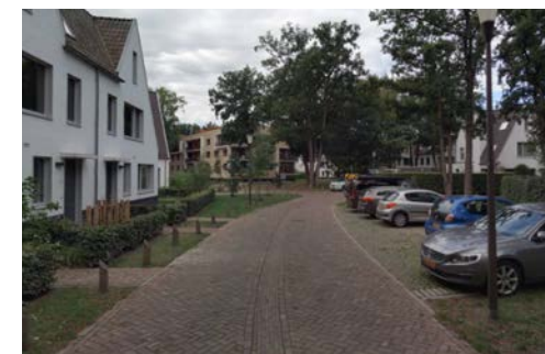
Fig. 3.12 Profieldoorsnede A-A' - Doorsnede woonhof met gelijkvloers profiel (rijbaan, voetpad en grasbetonparkeren op één niveau)
