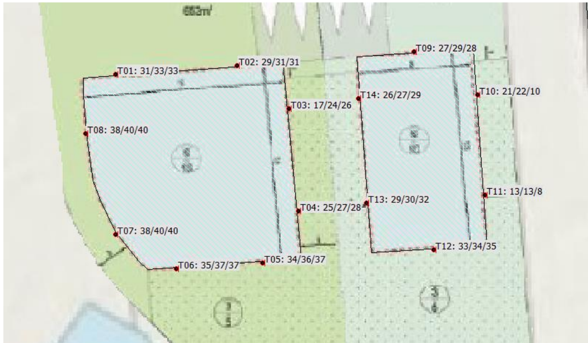
Afbeelding 7. Geluidbelastingen L_{den} (incl. aftrek art. 110g Wgh) Berekende geluidbelastingen op een hoogte van 1,5/4,5/7,5 meter boven het maaiveld
