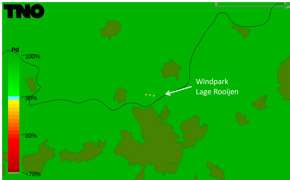
Figuur 8 Detectiekans van het primaire verkeersleidingsradarnetwerk op 1000 voet boven het bouwplan nadat deze is gerealiseerd. De locatie van de nieuwe windturbines is aangegeven met gele stippen.
