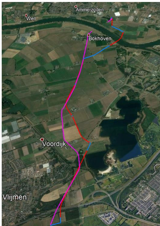
Figuur 2 Ligging van huidige tracé (roze) en toekomstig tracé (rood en blauw) (Achtergrond: Google Earth)
