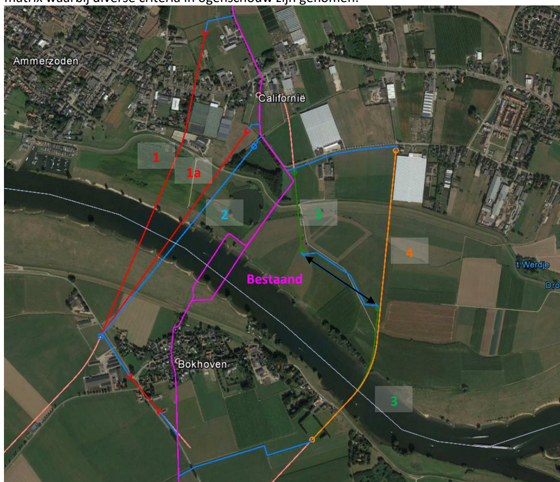
Figuur 1: Ontwikkelde routes DPO leiding Ammerzoden – Bokhoven (lichtblauw = open ontgraving, kleur = HDD)
