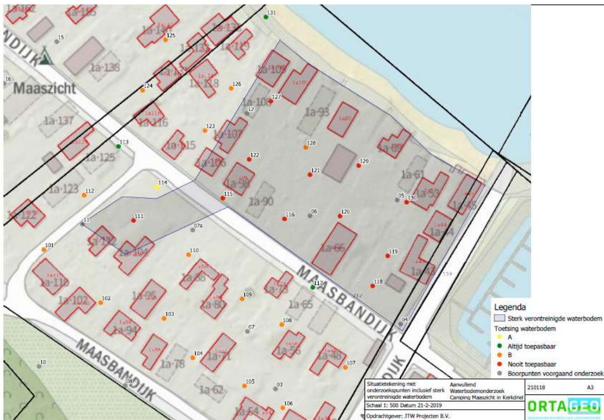
Afbeelding 3: Verontreinigingssituatie waterbodem zuidoostelijk terreindeel (bron: verkennend waterbodemonderzoek 2019)
