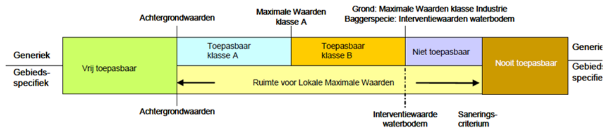
Figuur 1: Toepassingseisen als waterbodem
