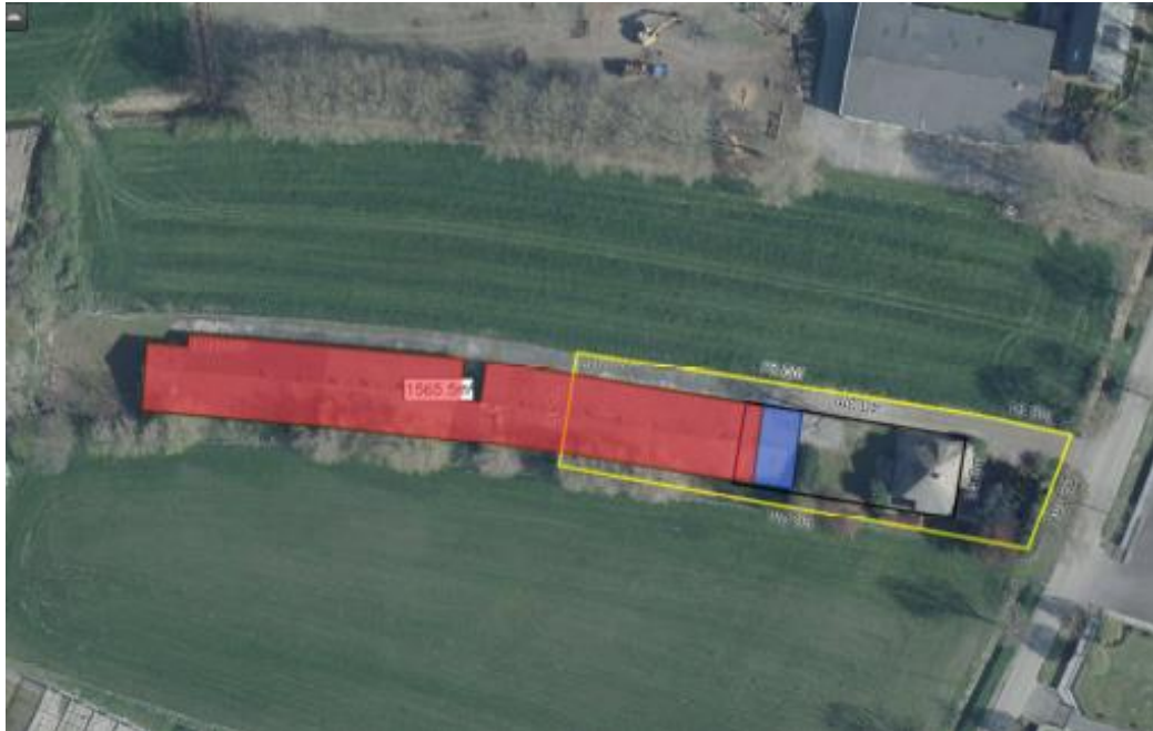
Figuur 2 Te slopen stallen (rood), indicatie bijgebouw (blauw), bestemming Wonen (geel), vlak bijbouwen (zwart).
