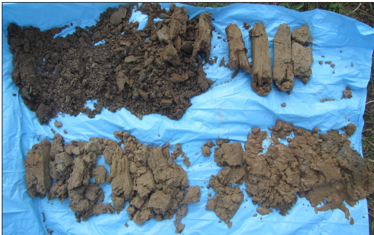
Figuur 9: Zicht op boring 2, uitgelegd van linksboven naar rechtsonder (0-200 cm -mv). Vanaf circa 120 cm -mv werden zandlagen aangeboord.
