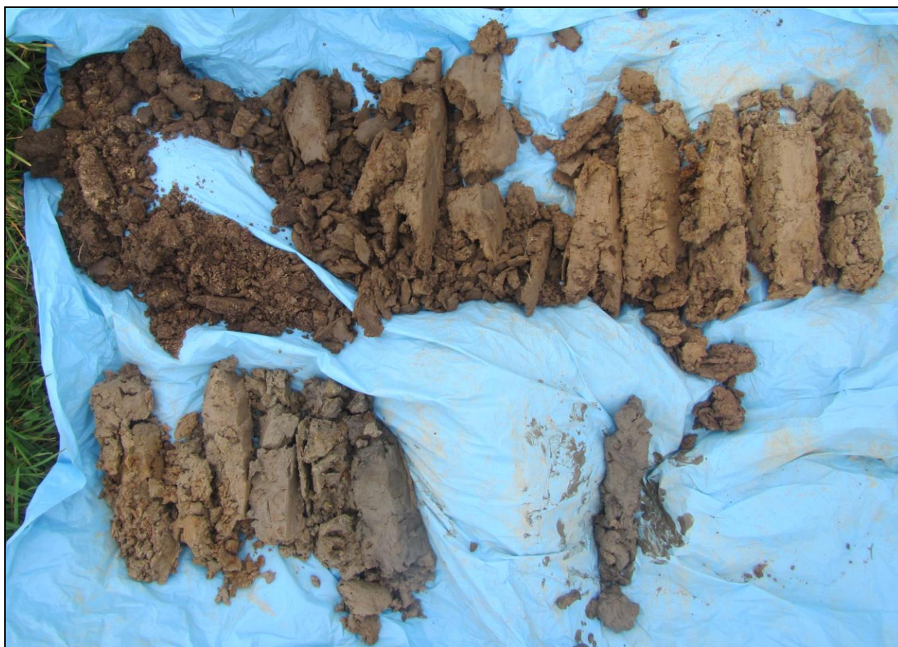
Figuur 8: Zicht op boring 1, uitgelegd van linksboven naar rechtsonder (0-220 cm -mv). Het bodemprofiel bestaat uit een afwisseling van siltige kleilagen.
