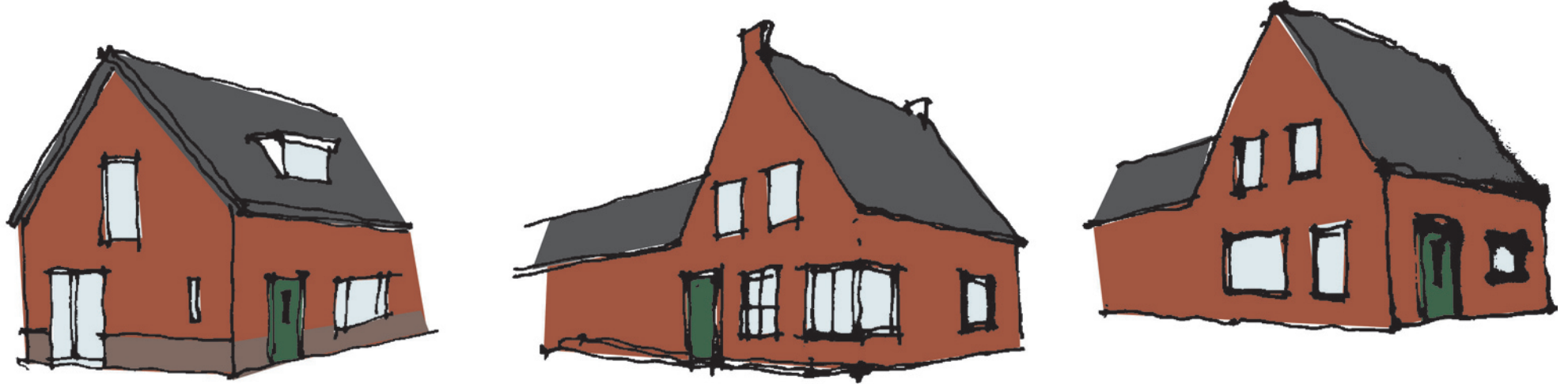
mogelijke uitwerkingen van dubbele orientatie hoekwoningen. vlnr: ramen in zijgevel, hoekraam, voordeur en ramen in zijgevel
