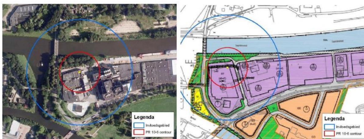
Afbeelding 17: Risicocontour en invloedsgebied ammoniakkoelinstallatie Friesland Campina (bron: bestemmingsplan 'Bedrijventerrein Goorseweg e.o.')
