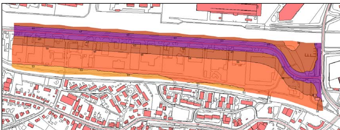
Figuur 19 Akoestische situatie wegverkeerslawaai gecumuleerd exclusief correctie artikel 110g Wgh, beoordelingshoogte 5 meter
