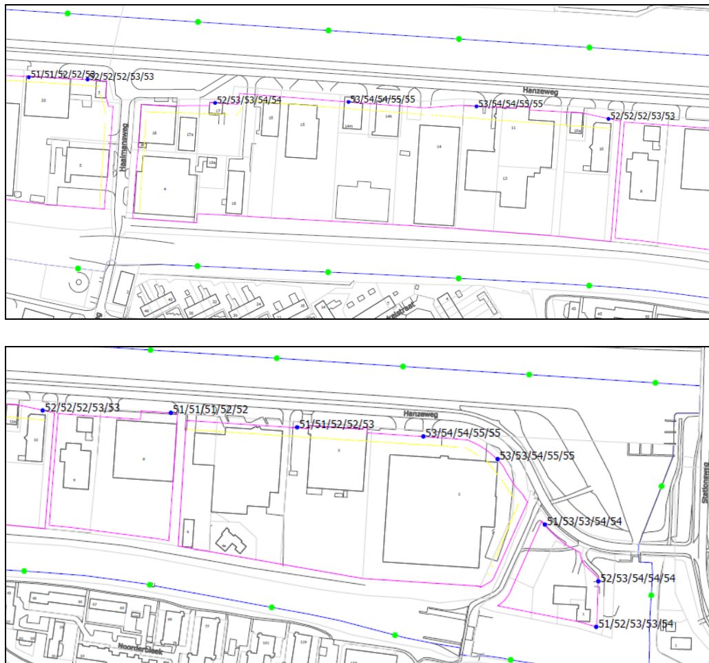
Figuur 8 Geluidsbelastingen op de beoordelingshoogten 2/5/8/11/14 meter inclusief correcties
