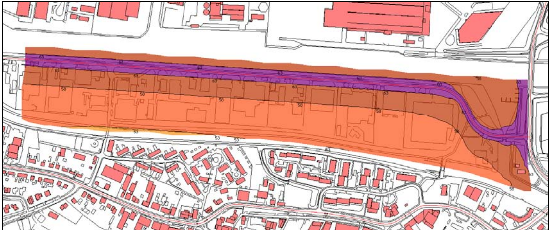
Figuur 20 Akoestische situatie wegverkeerslawaai gecumuleerd exclusief correctie artikel 110g Wgh, beoordelingshoogte 14 meter
