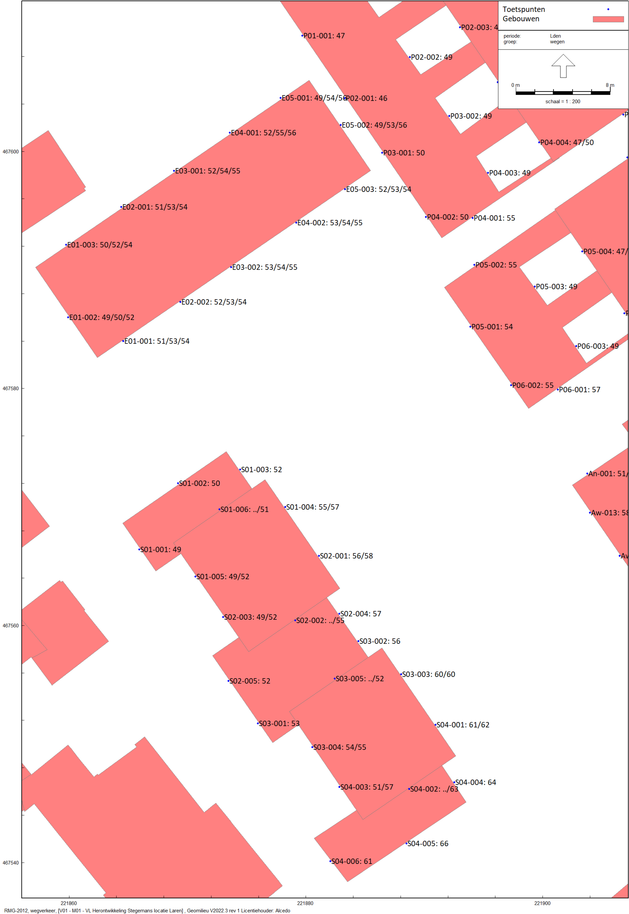
Figuur 6a Gecumuleerde geluidsbelastingen vanwege wegverkeer op de omliggende wegen exclusief 5 dB corr. ex. art.110g Wgh Beoordelingshoogte 1,5 / 4,5 en 7,5 meter
