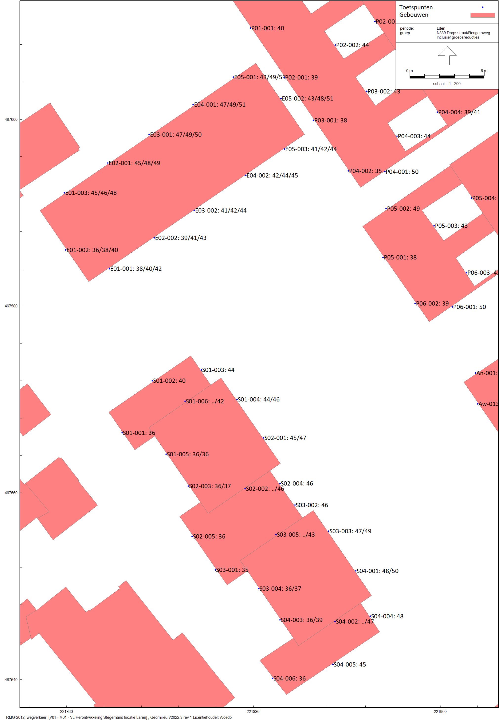
Figuur 3a Geluidsbelastingen vanwege wegverkeer op de N339 Dorpsstraat/Rengersweg inclusief 5 dB corr. ex. art.110g Wgh Beoordelingshoogte 1,5 / 4,5 en 7,5 meter
