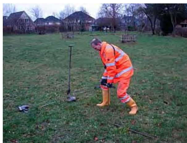
Afbeelding 2b: archeologisch booronderzoek met behulp van de zandguts ter plaatse van de onderzoekslocatie. Boring 003.
