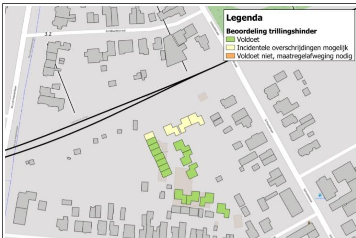
Figuur 18 – Beoordeling van de trillingen aan de SBR B-richtlijn voor nieuwe situaties (bron: We-Boost Data Trillingsonderzoek, 2021)
