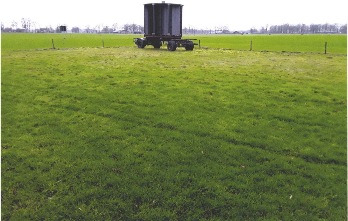
Afbeelding 2. Proefversie van windtoren op mobiele basis.
