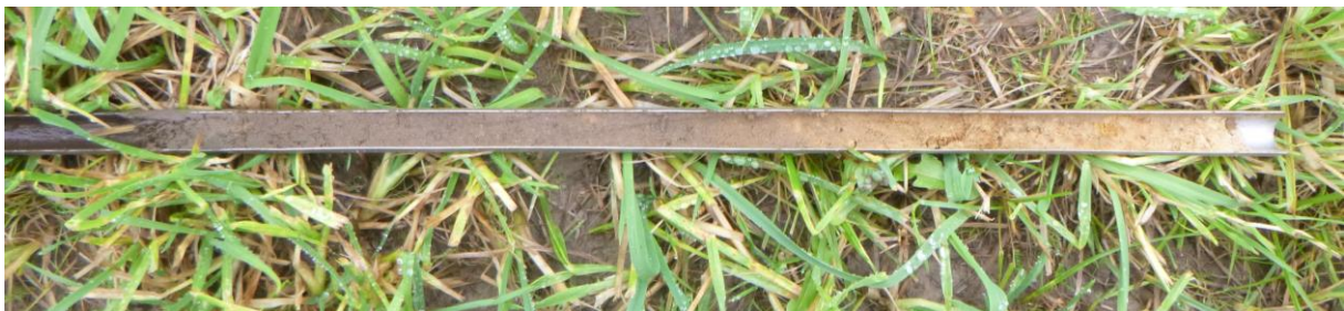
Figuur 20: Foto van de vergraven gley-horizont zoals deze op de boorpunten 1, 3, 4 en 5 is aangetroffen.
