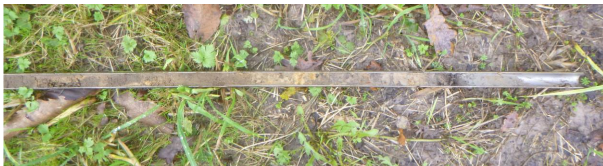
Figuur 21: Foto van het zeer dunne laagje plantenresten (rechts) dat op boorpunt 4 op ruim zeventig centimeter onder het maaiveld is aangetroffen. Links hiervan is een dik pakket opgebracht zand te zien dat bestaat uit geel zand met daarin brokken humeus zand.
