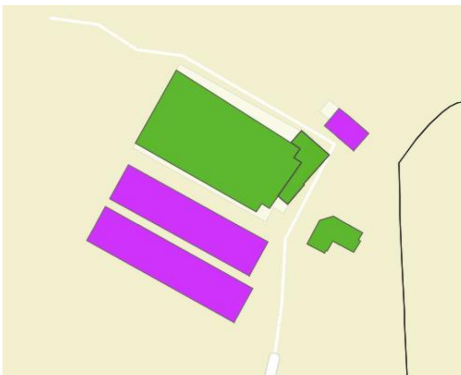
Figuur 6: Asbest-verdachte daken in het paars
