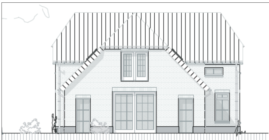
Zuidgevel nieuwbouw T-boerderij
