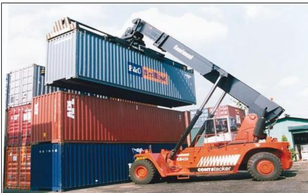
Figuur 9: een reachstacker tijdens container overslag werkzaamheden
