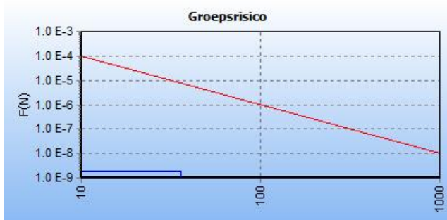
Figuur 6 FN-curve van de kilometer met de hoogste overschrijdingsfactor van gastransportleiding N-560-07 in de huidige situatie. De ligging van deze kilometer is hiernaast in het rood weergegeven op een topografische kaart.
