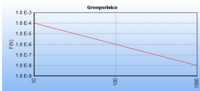
Figuur 8 FN-curve van de kilometer met de hoogste overschrijdingsfactor van gastransportleiding N-558-70 in de toekomstige situatie. De ligging van deze kilometer is hiernaast in het groen weergegeven op een topografische kaart.
