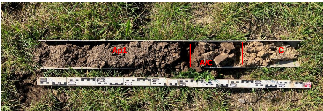
Afbeelding 15: Boring 11 met verstoord bodemprofiel.
