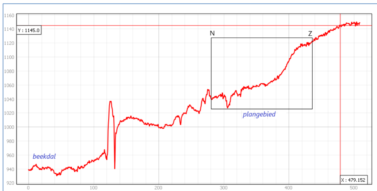
Figuur 16. Een dwarsdoorsnede van de maaiveldhoogtes, vanaf het noordelijkgelegen lagere beekdal in de richting van de zuidelijke dekzandrug.
