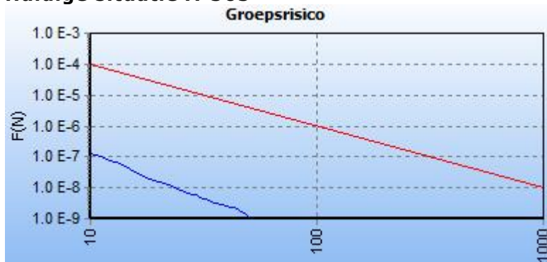
Figuur 5.1 – fN-curve hogedruk aardgasleiding A-505 huidige situatie
