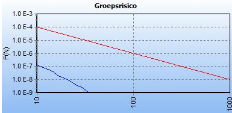
Figuur 5.4 – fN-curve hogedruk aardgasleiding A-505 toekomstige situatie inclusief Dorpsstraat 4 & 10
