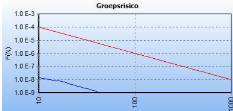
Figuur 5.13 – fN-curve hogedruk aardgasleiding A-662 huidige situatie
