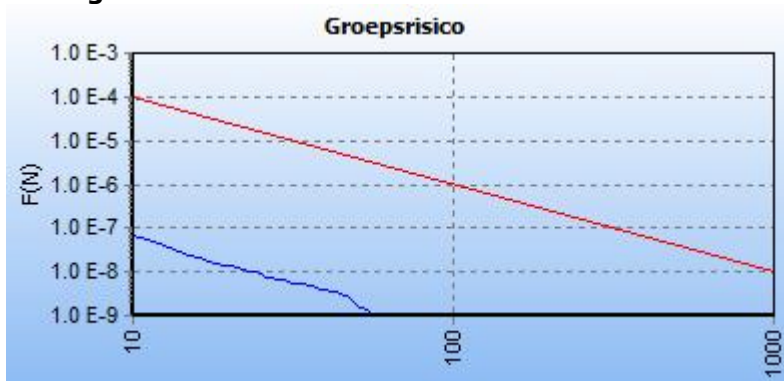
Figuur 5.9 – fN-curve hogedruk aardgasleiding A-608 huidige situatie
