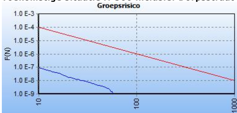
Figuur 5.6 – fN-curve hogedruk aardgasleiding A-506 toekomstige situatie inclusief Dorpsstraat 4
