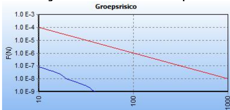
Figuur 5.8 – fN-curve hogedruk aardgasleiding A-506 toekomstige situatie inclusief Dorpsstraat 4 & 10
