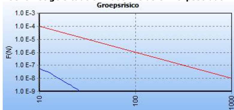
Figuur 5.12 – fN-curve hogedruk aardgasleiding A-608 toekomstige situatie inclusief Dorpsstraat 4 & 10
