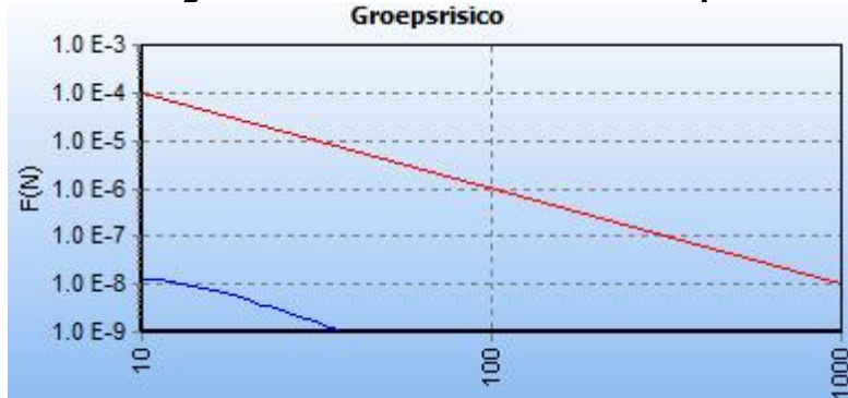
Figuur 5.15 – fN-curve hogedruk aardgasleiding A-662 toekomstige situatie inclusief Dorpsstraat 10
