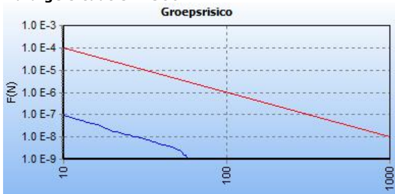
Figuur 5.5 – fN-curve hogedruk aardgasleiding A-506 huidige situatie
