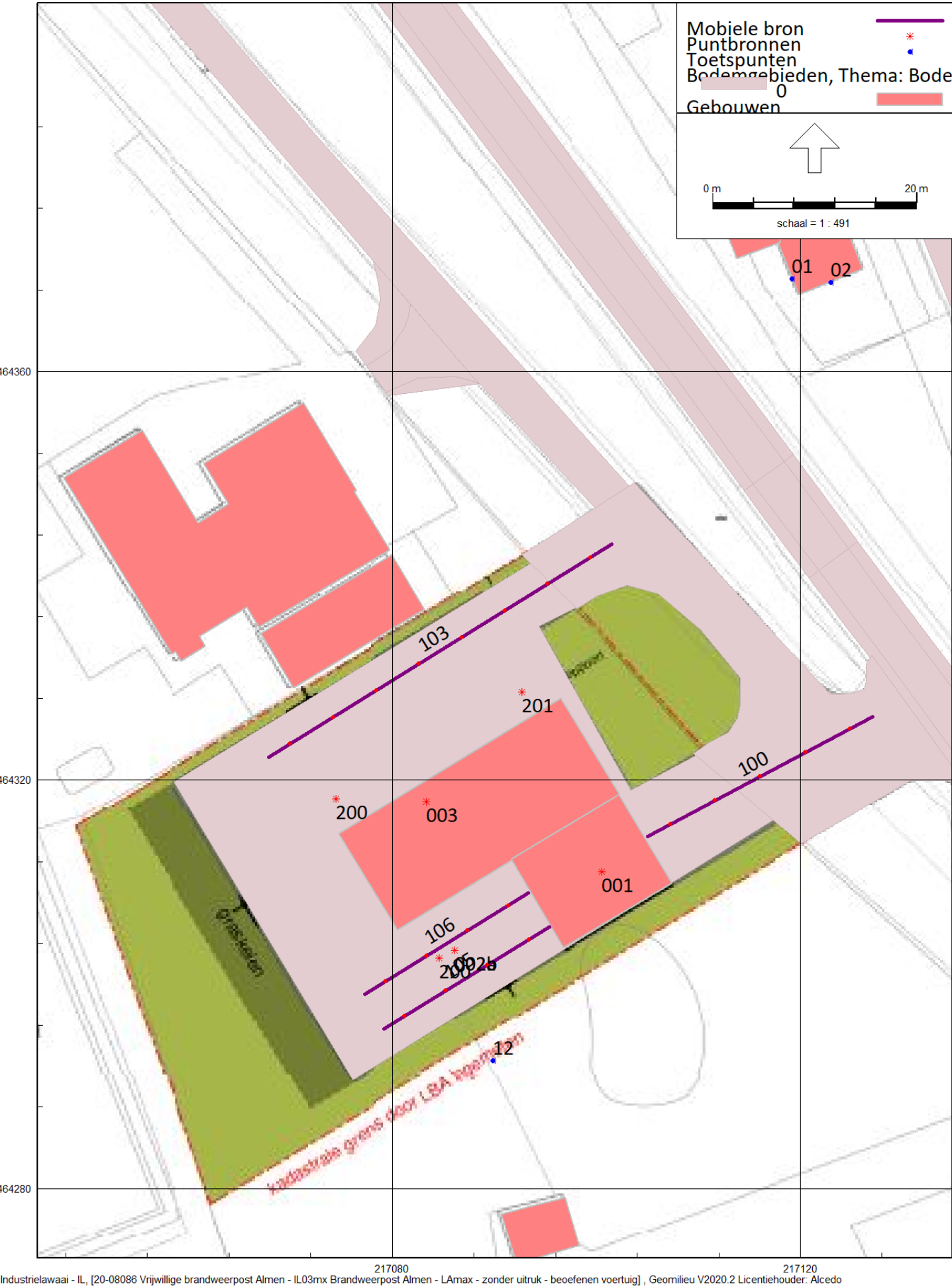
Figuur 10 | Posities van geluidsbronnen van maximale geluidsniveaus (LMax)
