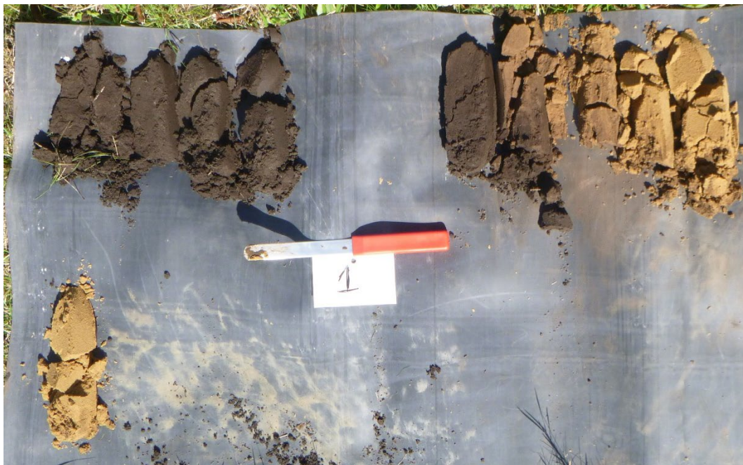
Afb. 7. Boring 1, uitgelegd van links naar rechts, gegroepeerd per 50 cm.
