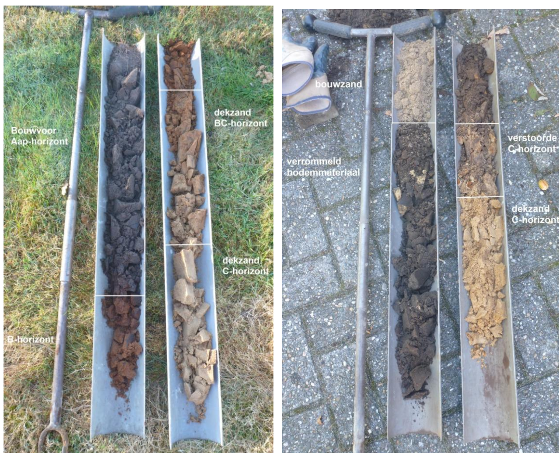
Fig. 3.1: Opgeboorde bodemmateriaal van boring 1 (linker foto) en van boring 3 (rechter foto).
