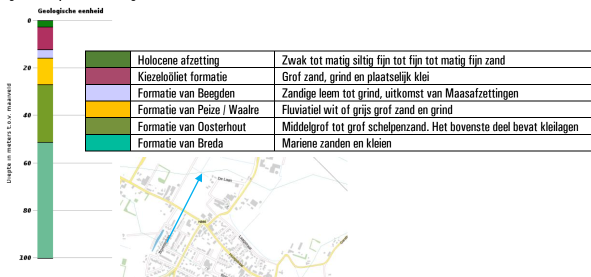
Figuur A: opbouw ondergrond.
