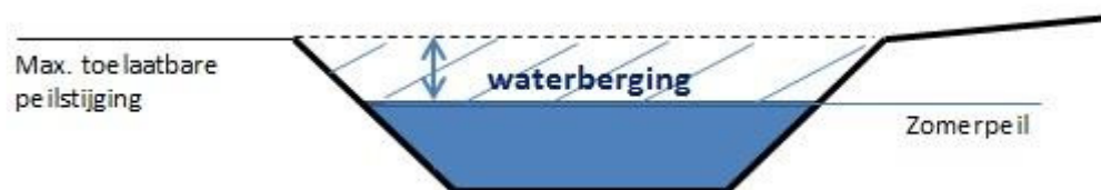
Figuur 2: voorbeeld waterberging in oppervlaktewater
