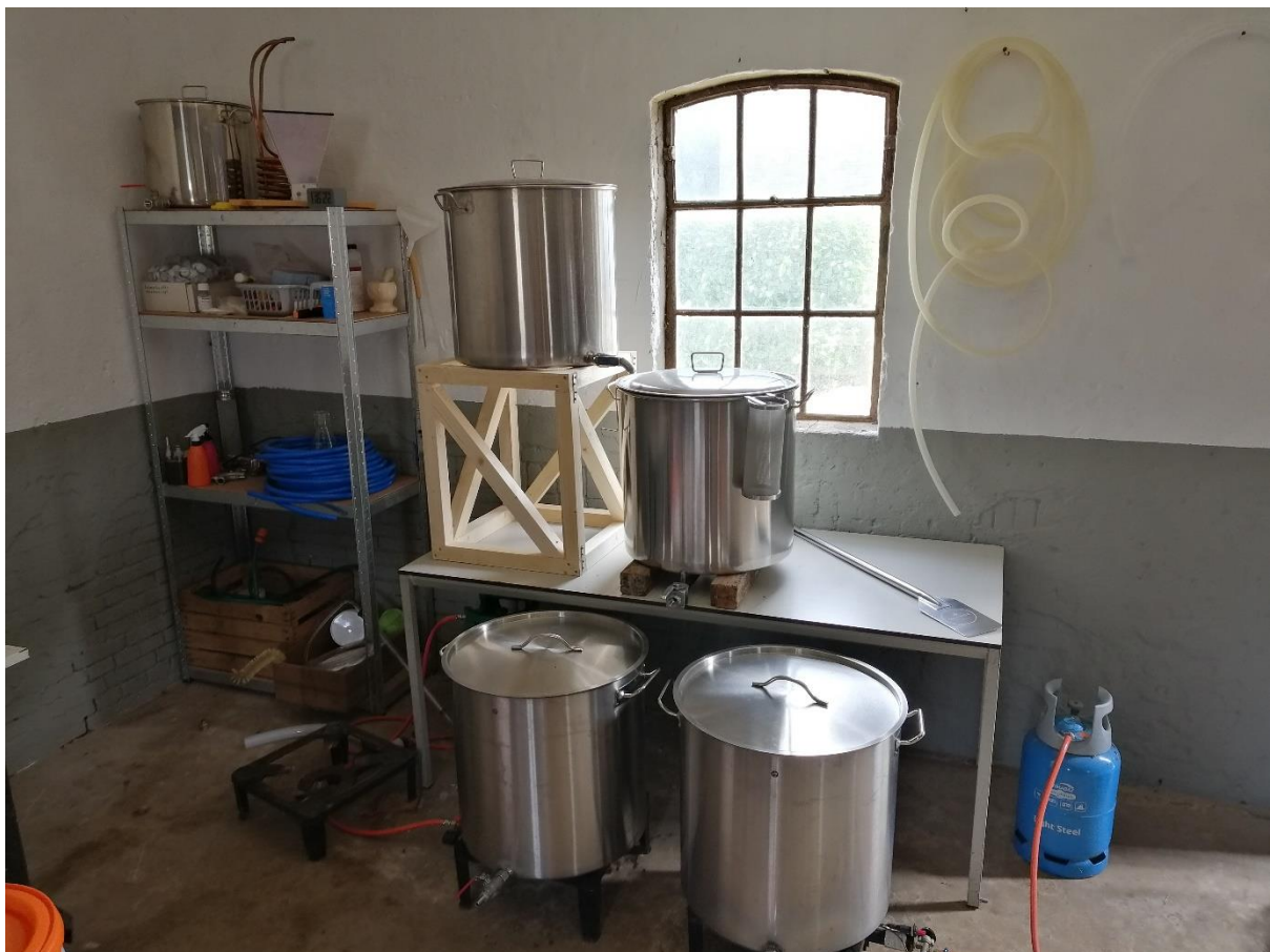
Foto van de brouwopstelling. Met deze brouwinstallatie kan 100 liter bier gemaakt worden.
