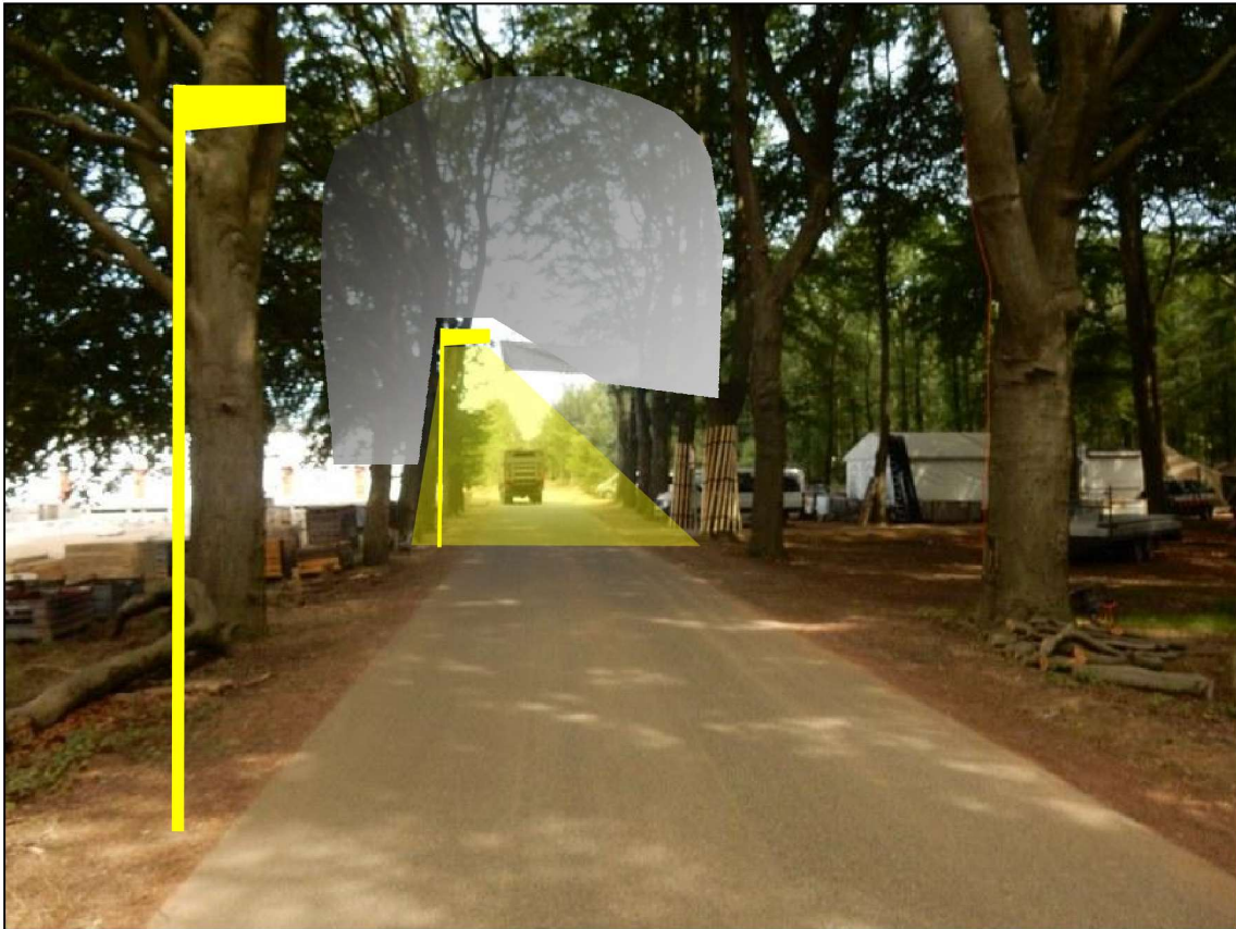
Figuur 16. Door het plaatsen van verlichting op palen met naar beneden gerichte armaturen, ontstaat een donkere baan onder de boomkronen waar vleermuizen langs kunnen vliegen zonder hinder te ondervinden van het licht.
