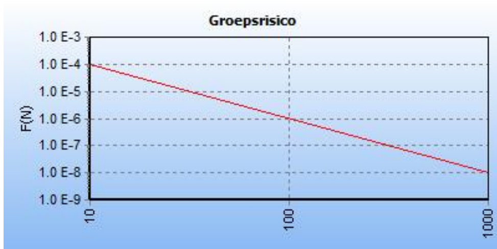
Figuur 9: FN-curve van het GR. Te zien is dat er geen GR berekend wordt.
