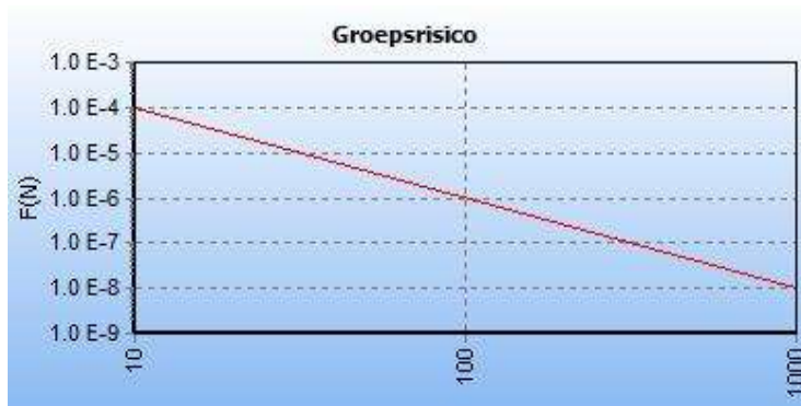
Afbeelding 6 fN-curve buisleiding N-576-73-deel-1, huidige situatie
