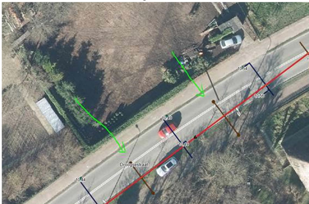
Figuur 13 Bestaande riolering en aansluiting daarop
