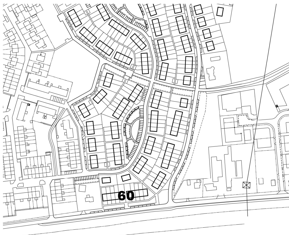
Afbeelding 9 - Geluidbelasting op 7,5 meter boven de voorkeursgrenswaarde vanwege spoorweglawaai. De gevel op 7,5 m. worden niet voorzien van te openen delen.
