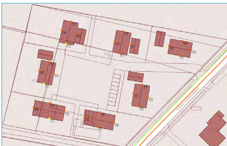
Figuur 5 Gecumuleerde geluidbelasting L_{den} (dB)
