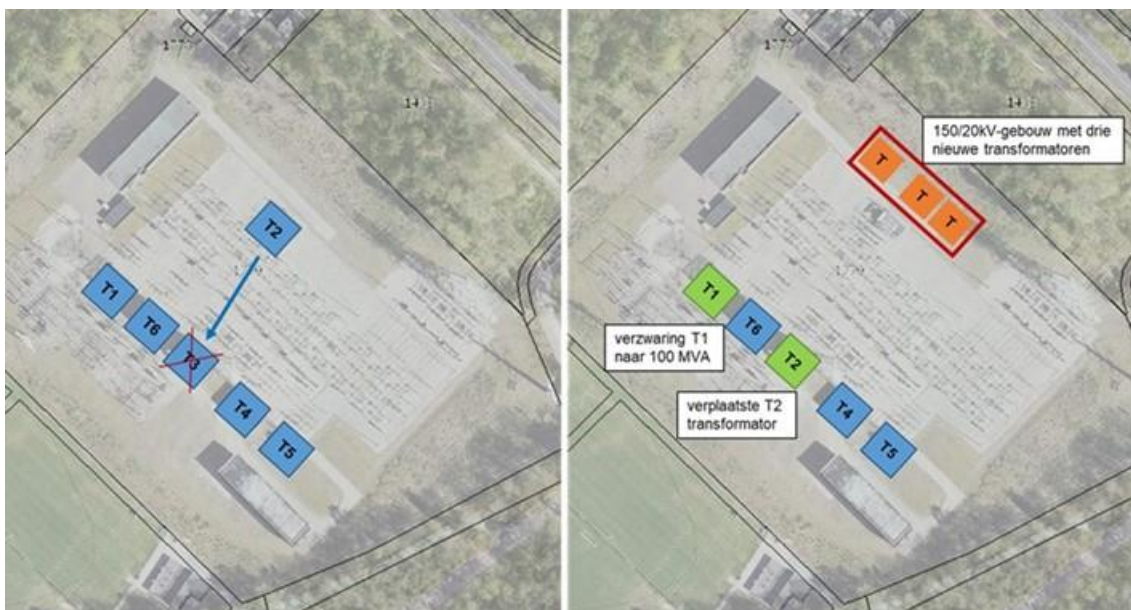
afbeelding 10: wijzigingen aan de transformatoren
