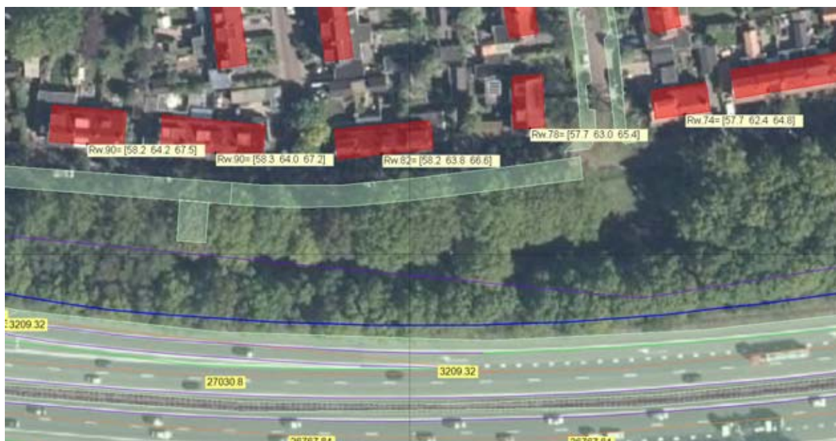
Geluidbelasting L_{den} in dB vanwege de A28 – zonder aftrek – conform GPP Zonder containerscherm (Hw=1.5, 4.5, 7.5m)
