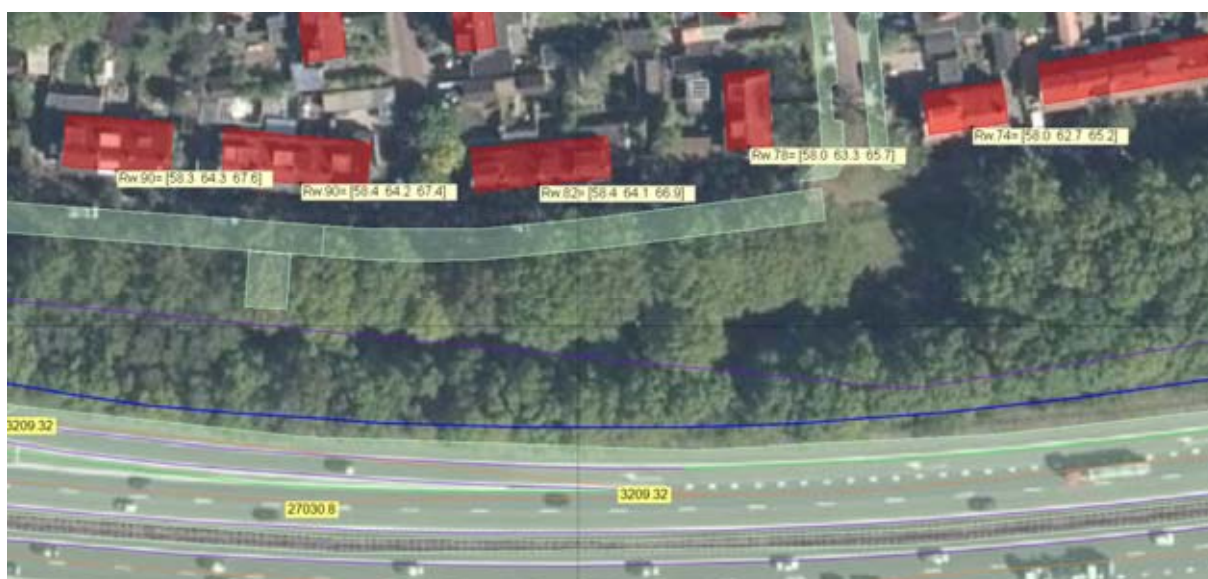
Geluidbelasting L_{den} in dB vanwege de A28 – zonder aftrek– conform GPP Containers, 5.8m hoog begroeiing na 2-3 jaar (refl. 50%, Hw=1.5, 4.5, 7.5m)
