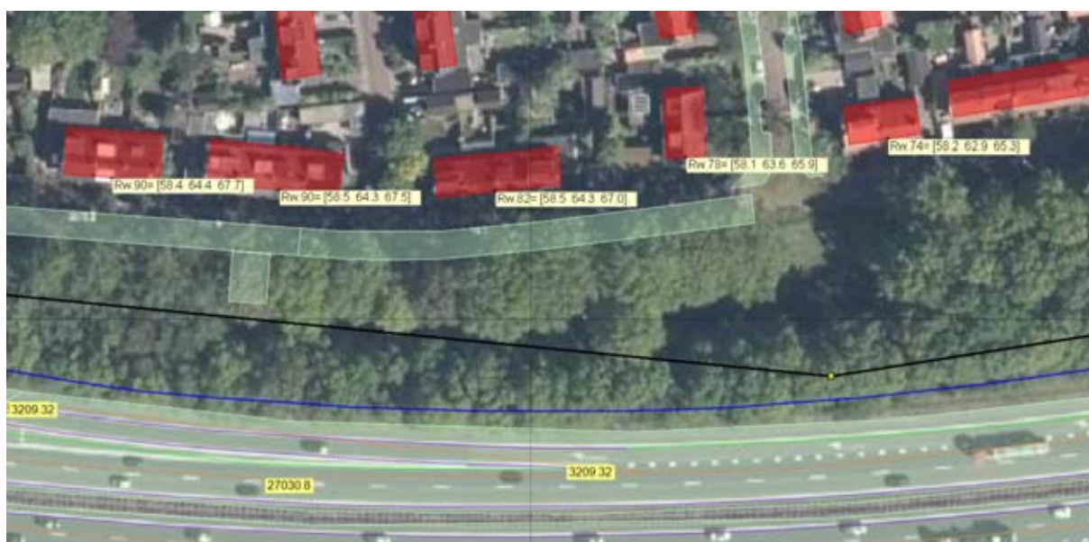
Geluidbelasting L_{den} in dB vanwege de A28 – zonder aftrek– conform GPP Containers, 5.8m hoog zonder begroeiing (refl. 80%, Hw=1.5, 4.5, 7.5m)
