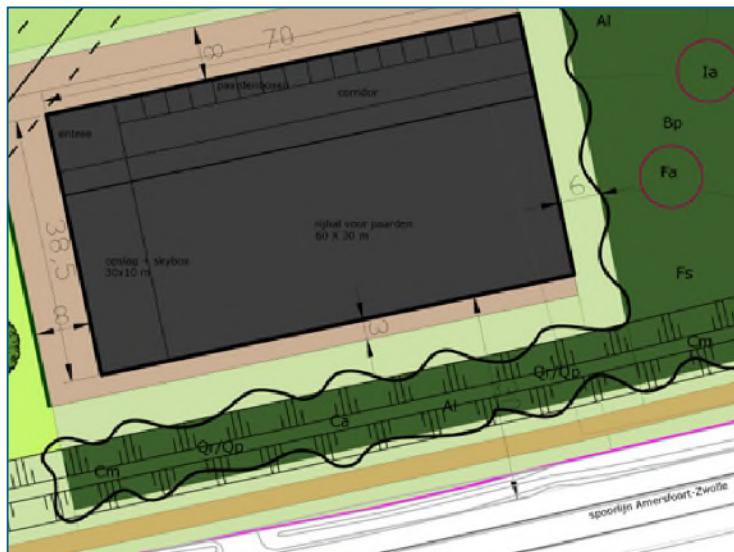
Figuur 3.4: Uitsnede voorlopig ontwerp. Tussen de rijhal en de spoorlijn is een afstand van 30 meter aangehouden
