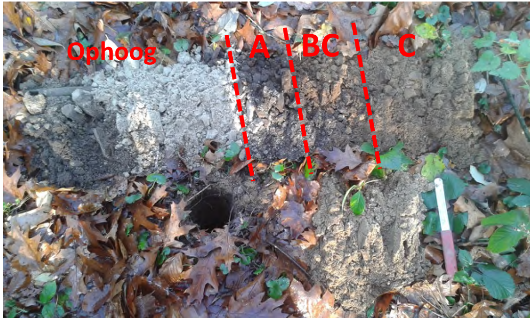
Abbeelding 7: Boring 05 met onder de ophooglaag de oude A-horizont, restant B-horizont en de geleidelijke overgang naar de C-horizont (foto Antea Group).
