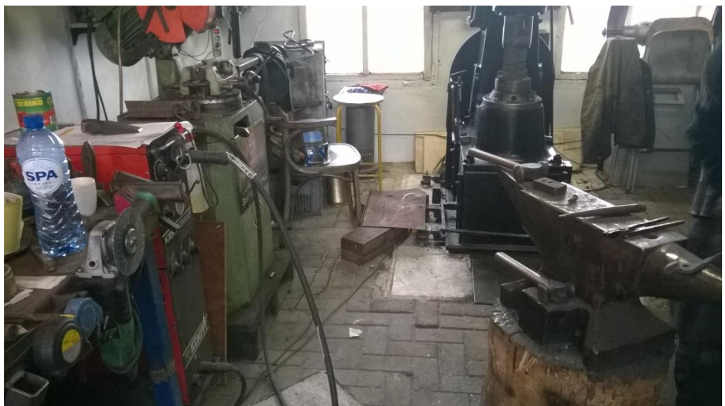
Figuur 2-2 Pneumatische hamer (achter) en aambeeld (rechts)
