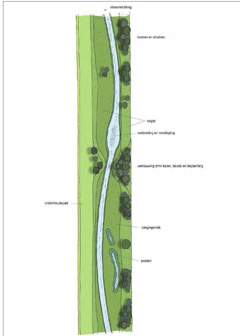
Uitsnede principe meandering Groesbeek (bron: Voorlopig ontwerp Beekherstel Groesbeek, BWZ Ingenieurs).
