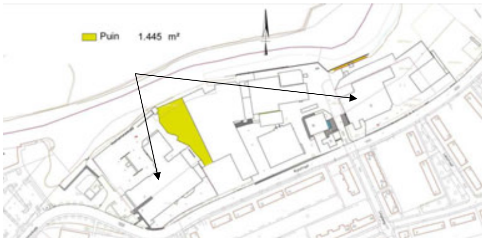
Figuur 23. Verharding met puin in de bestaande situatie.
