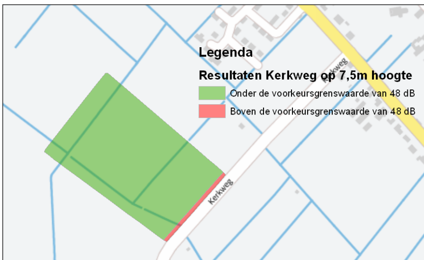
Figuur 4: resultaten Kerkweg op 7,5 meter hoogte, 48 dB contour op minder dan 10 m van wegas.
